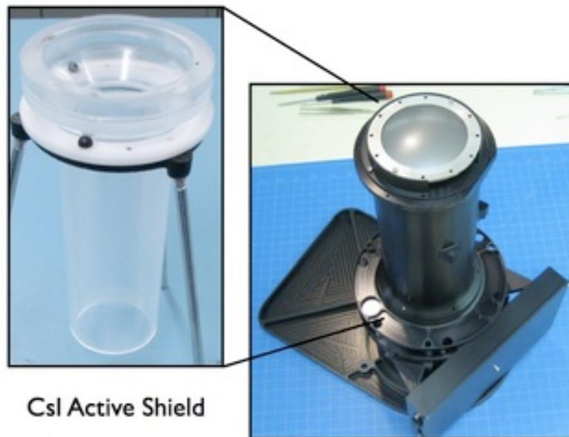
図 4.4: (左) NuSTAR 衛星の CsI アクティブシールド. (右) アクティブシールドを収める曲面型のベリリウム入射窓を備えた筐体 (<https://www.nustar.caltech.edu/page/detectors>)
