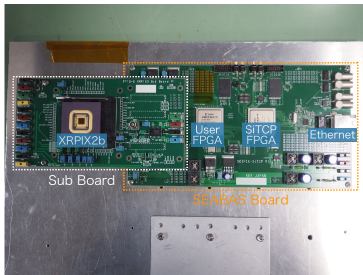
図 3.5: SOI ピクセル検出器のデータ読み出しボード。
