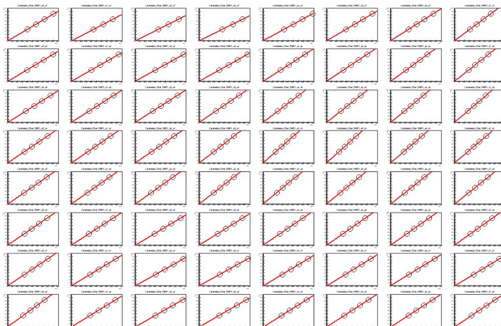
図 4.12 シンチレータ各ピクセルのエネルギー較正。横軸、縦軸がそれぞれ各線源のピークの ADC 値、エネルギーとなっている。
