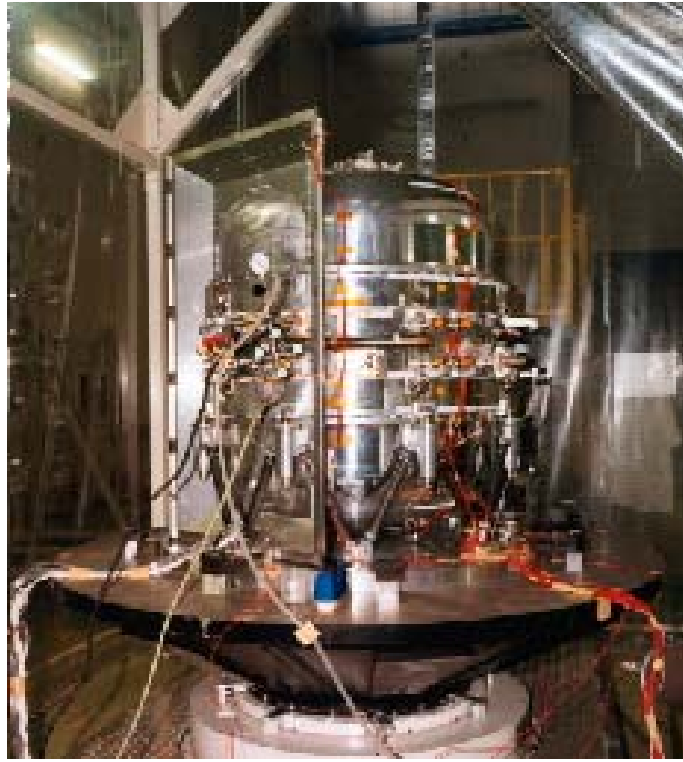
図 1.6: XRS 冷却システム外観
