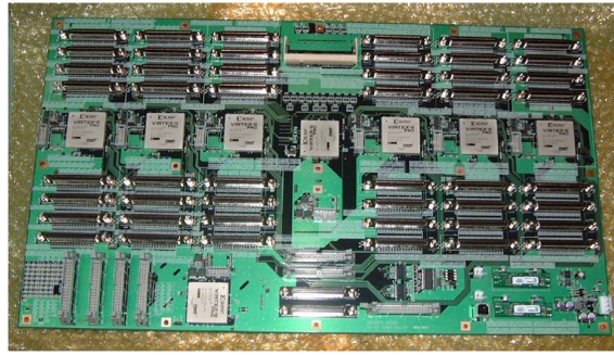
図 4.21: 位置情報変換する FPGA 搭載エンコーダー
