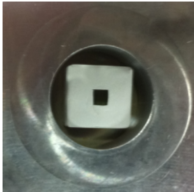
図 7.8: 入射窓に \text{LaF}_3(\text{Nd})(20 \times 20 \times 20 \text{mm}^3) 結晶を取り付けた様子
