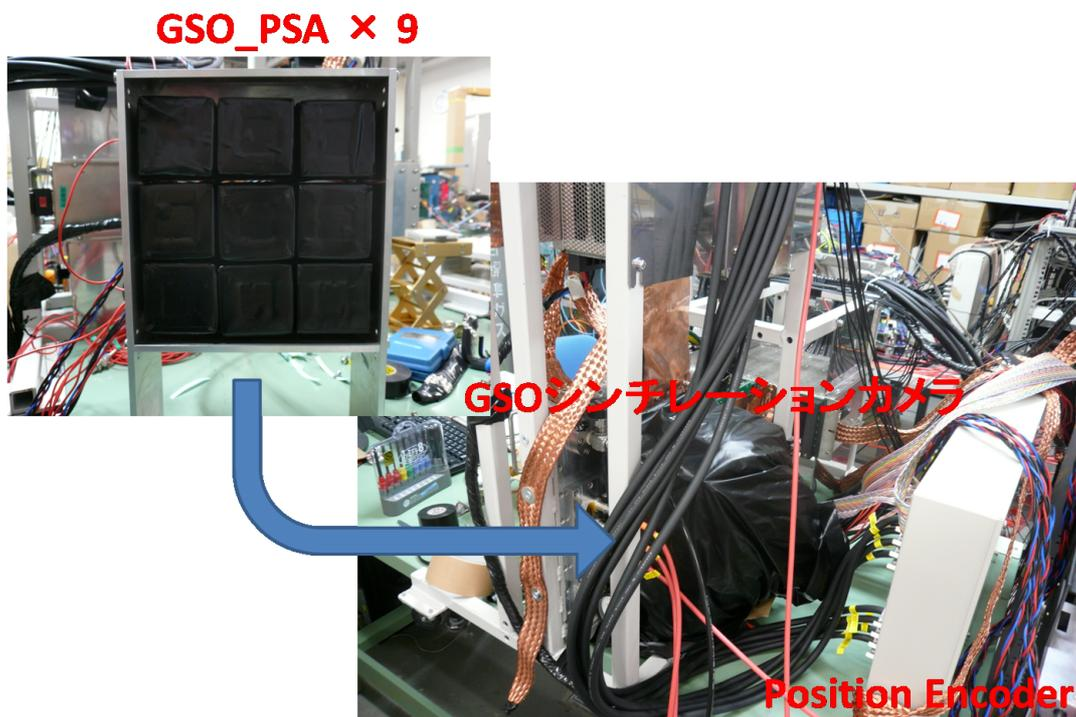
図 4.25: トリガーに用いた GSO アレイのシンチレーションカメラ
