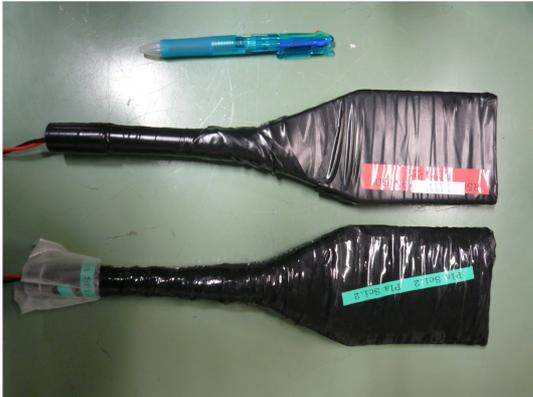
図 4.33: プラスティックシンチレータ
