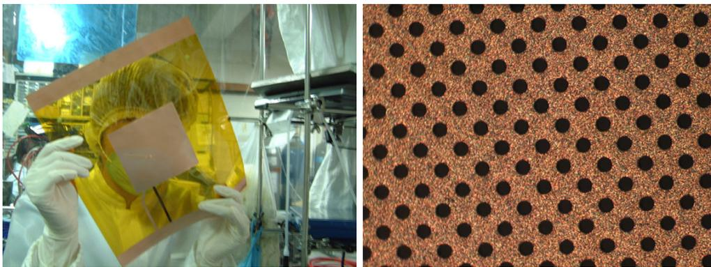
図 3.13: GEM の写真と電子顕微鏡写真。径の直径  $70 \mu\text{m}$ 、穴のピッチ  $140 \mu\text{m}$ 。[33]
