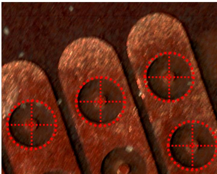
図 7.22: 改良した連結型 20cm 角 \mu -PIC の電極の顕微鏡写真 (SN100826-1)。赤の破線はカソードリングとその中心を表わす。
