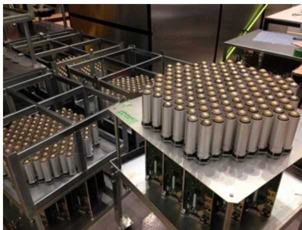
図 4.20 ミニカメラ試験を行った実験室 (カナリア天体物理研究所 (スペイン)) の写真。光検出器 19 モジュールごとに、モジュールホルダーに差し込んで管理している。
