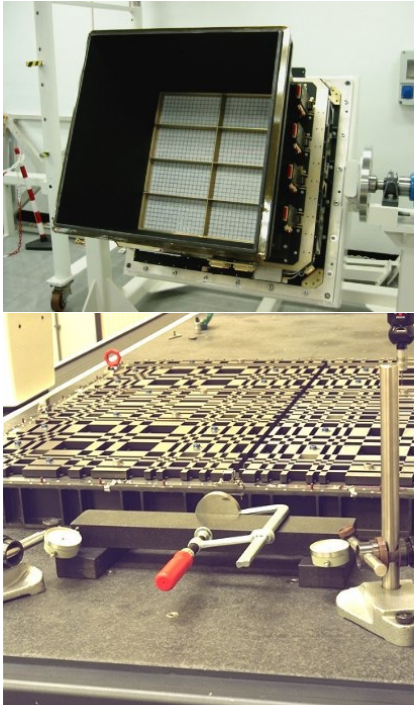
図 2.18 IBIS の構成図。ガンマ線検出器 (上) と、コーデッドマスク (下)。[32]
