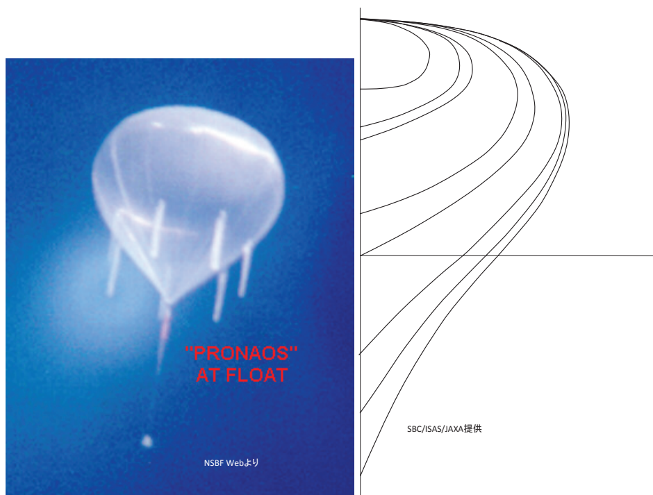
図 4.4: ゼロプレッシャー気球 左: 望遠写真 右: 形状
