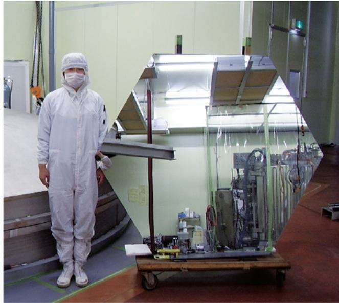
図 3.14 1.5 m サイズ高精度分割鏡 [45].
