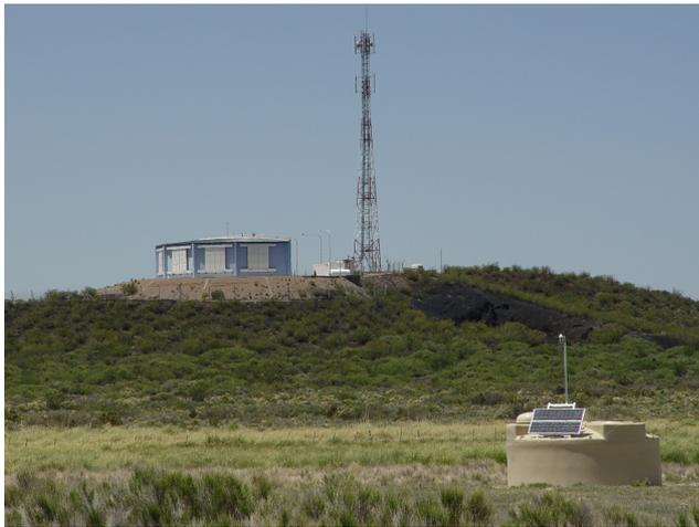
図 1.9 Pierre Auger Observatory の地上検出器 (手前) と大気蛍光検出器 (奥). 地上検出器には 12000 l の水が入れている. Pierre Auger Observatory website <http://www.auger.org/>より.
