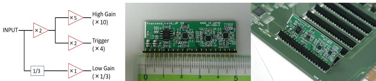
図 4.8 メインアンプ version2 のブロック図 (左) と写真 (中央) と読み出し回路との接続 (右).
