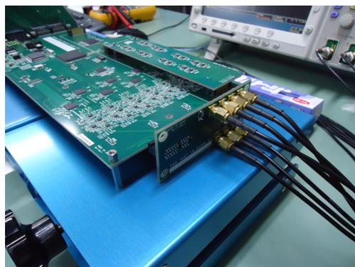
図 5.4 試験の際に用いる読み出し回路へのテストパルス入力用基板.
