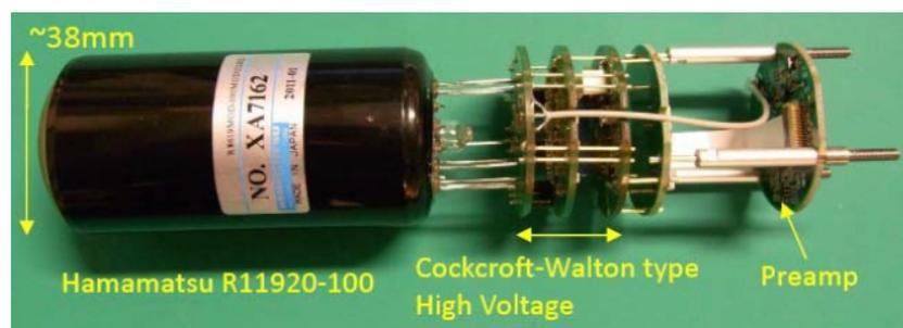
図 3.15 浜松ホトニクス社製 PMT, Cockcroft-Walton 高圧回路, プリアンプ回路で構成される PMT モジュール。PMT 側面には黒色の磁気シールドが巻かれている [46].
