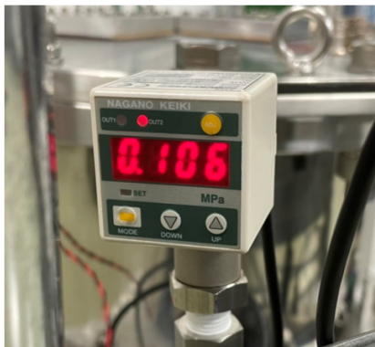
(a) 気圧計: ベッセル内の気圧をモニタリングする。
