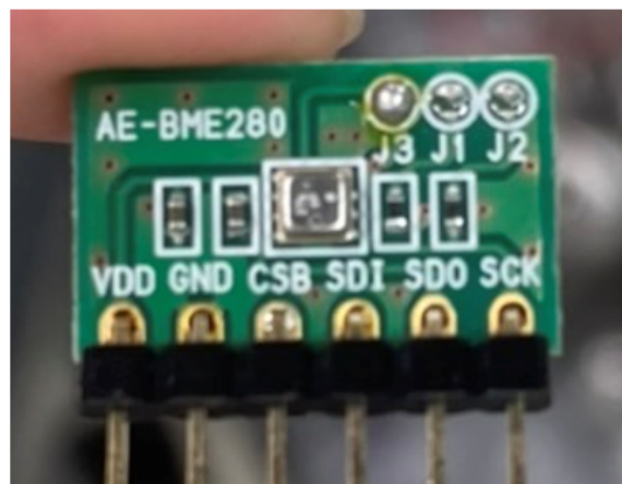
(b) 湿度計: ベッセル容器周りの湿度をモニタリングする。
