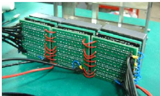
図 4.32: 192\text{ch} を抵抗チェーンで 16\text{ch} 読み出し 図 4.33: プロトタイプシンチレーションカメラ概念図
