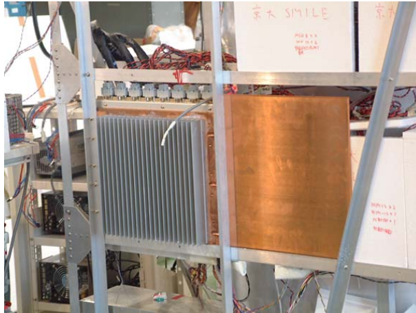
図 6.14: 銅版により放射面を拡張した電圧変換モジュール
