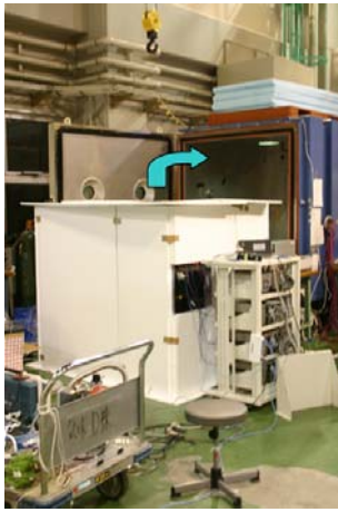
図 6.36: 最終環境試験の様子。このようにベッセルおよび Gondola 枠を発泡スチロールで囲み真空恒温層へ入れる。
