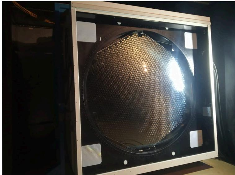
図 2.9 LST 2号機の焦点面カメラ (credit:T.Saito)
