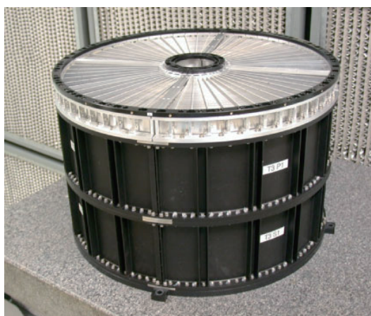
図 4.3: すざく XRT 外観 (The Suzaku Technical Description)。
