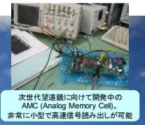
次世代望遠鏡に向けて開発中のAMC (Analog Memory Cell)。非常に小型で高速信号読み出しが可能
