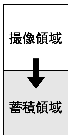
図 2.5: Frame Transfer 型転送方式
