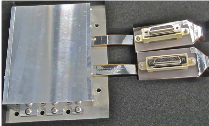
図 5.1 2 つの FPC 熱試験用 CCD 素子が納められたキャリアケースと FPC
