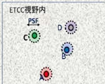
ETCCで各線源対応するガンマ線がその点に集光するので各点毎に異なる正しいエネルギースペクトルが測定できる。
